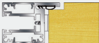
Vue de coupe de l'huissierie porte bois Section view with wooden door
