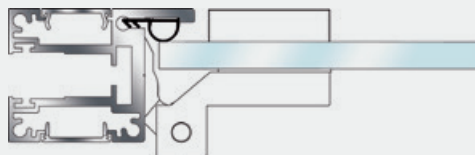
Vue de coupe de l'huissierie porte verre Section view with glazed door
